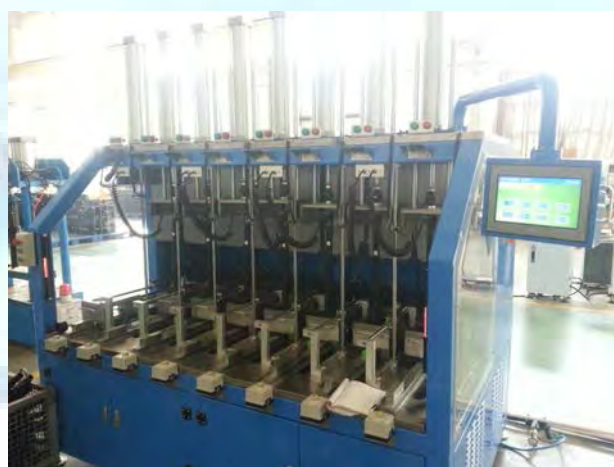
燃气塑钢转换管检漏装置
